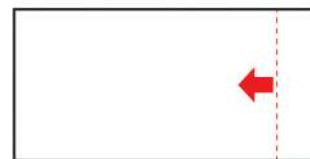
สามารถเลือกติดตั้งแผ่นจากป็นลมด้านใดด้านหนึ่ง ไปหาป็นลมอีกด้านหนึ่ง แผ่นต้องตั้งฉากกับโครงหลังคา
