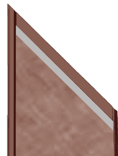
3.3 ใช้กรรไกรตัดเหล็กตัดแผ่นหลังคา เมทัล เอสซีจี รุ่น คอมฟอร์ท ลอน Snap Lock ตามแนวตะโงั่วสัน แล้วนำไปติดตั้งตามมาตรฐานติดตั้ง
