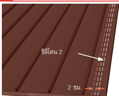
2.1 ยาแนวกันน้ำด้วย ซิลิโคน หลังแผ่น 2 เส้น ระยะห่างจากแนวครอบ 2 ซม.
