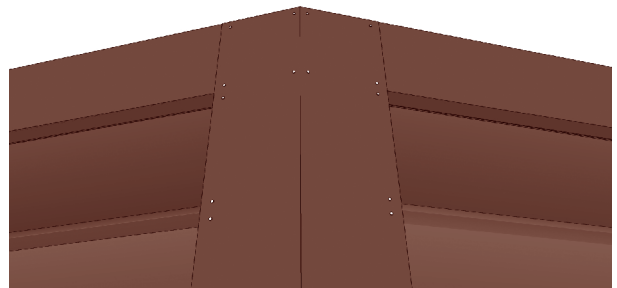
4.4 นำครอบสันหลังคาวางประกบจัดแนวติดตั้งให้ตรง ยึดด้วยตะปูเกลียวยึดหลังคาเหล็กหัวแบน #10-24x13 มม. ปลายสว่าน เอสซีจี เข้ากับครอบปั้นลม
