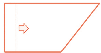
ติดตั้งแผ่นจากบันลัมไปหาตะเข้สัน หรือรางน้ำ วางแผ่นเสมอ ขอบนอกไม้บัวบันลัม แผ่นต้องตั้งฉากกับโครงหลังคา
