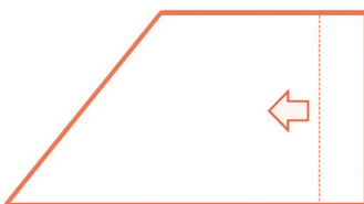
ติดตั้งแผ่นจากบันลัมไปหาตะเข้สันหรือรางน้ำ วางแผ่นเสมอ ขอบนอกไม้บัวบันลัม แผ่นต้องตั้งฉากกับโครงหลังคา
