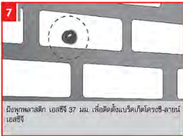
ติดตั้งแบร็คเก็ตติดโครง ซี-ลายน์ เอสซีจี ด้วยตะปูเกลียว ปลายแหลม เอสซีจี 38 มม.
