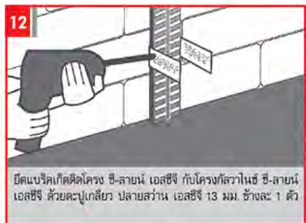
ติดโครงกัลวาไนซ์ ซี-ลายน์ เอสซีจี โดยให้แนวเส้นบักเต้าเสมอหน้าโครง
