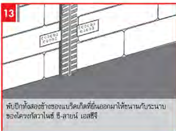
ติดตั้งโครงให้ครบทุกจุด แล้วติดตั้งไม้ฝา เอสซีจี ตามคู่มือติดตั้ง หน้า 7
