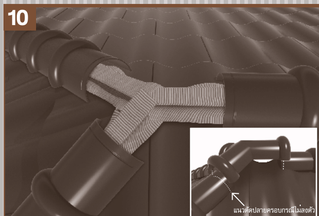
บริเวณจุดต่อระหว่างครอบตะเวีสันและครอบสันหลังคา ให้คลุมแผ่นรองได้ครอบทับกันอย่างน้อย 10 ซม. กรณีวางครอบโค้ง 3 ทาง ไม่พอดีให้ตัดปลายครอบสันโค้งออกทั้ง 3 ด้าน พร้อมเขาระงัดก้านด้วย
