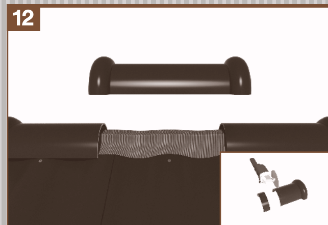
ที่กึ่งกลางสันหลังคาให้ติดตั้งครอบโค้ง 2 ทางปิดทับ หากวางครอบโค้ง 2 ทาง ไม่ลงตัวให้ตัดปลายครอบสันโค้งทั้งสองด้านเฉลี่ยให้เท่ากัน พร้อมเจาะรูค้ำน้ำที่ปลายครอบด้วย การติดตั้งครอบสันโค้งที่สันหลังคา ต้องได้แนวตรงตลอด แผ่นรองใต้ครอบต้องไม่โผล่เลยครอบออกมา
