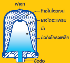
โครงสร้างถังแรงดันก๊าซไนโตรเจน
