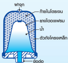
โครงสร้างถังแรงดันไนโตรเจน
