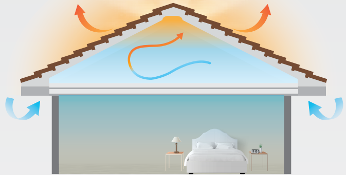
ภาพการทำงานของกระเบื้องระบายอากาศ เอสซีจี
