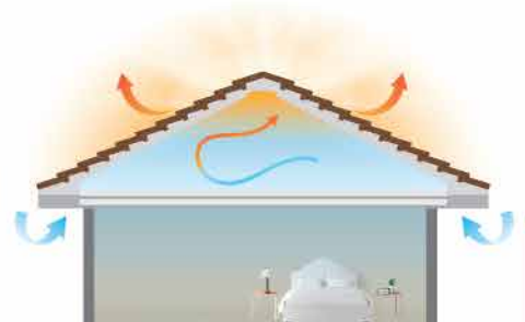
ภาพการทำงานของกระเบื้อง ระบายอากาศ เอสซีจี
